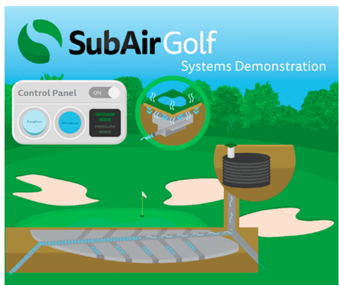
Prinzip der Entwässerung; beide Systeme können über firmeneigene Software-Lösungen gesteuert und kontrolliert werden.
