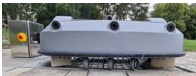
Bis zu 10.000 Rangebälle pro Tag sammelt der ECHO RP-1200 und entlädt diese über einer speziellen Grube (Droppit) mit Gitter, ...
