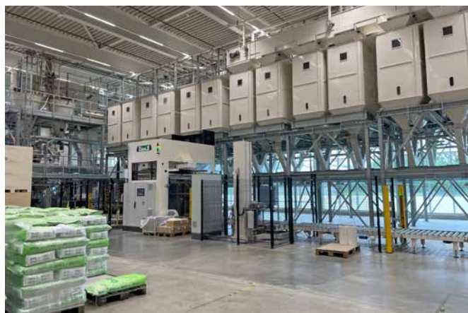
Foto 1: OHS-Saatgutmischanlage mit 48 Vorratssilos. (Alle Fotos: H. Nonn)
