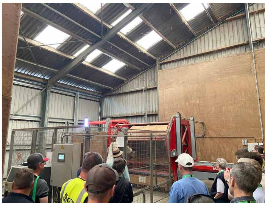
Abb. 1: Die Saatgutkisten werden vollautomatisch per Roboter gereinigt.
