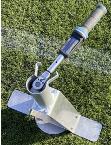
Abb. 5: Rotationswiderstandsgerät. Version 1 mit eingeschränktem Drehwinkel.
