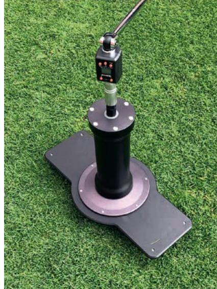
Abb. 8: Leichtes Drehwiderstandsgerät. (Foto: H. Nonn)
