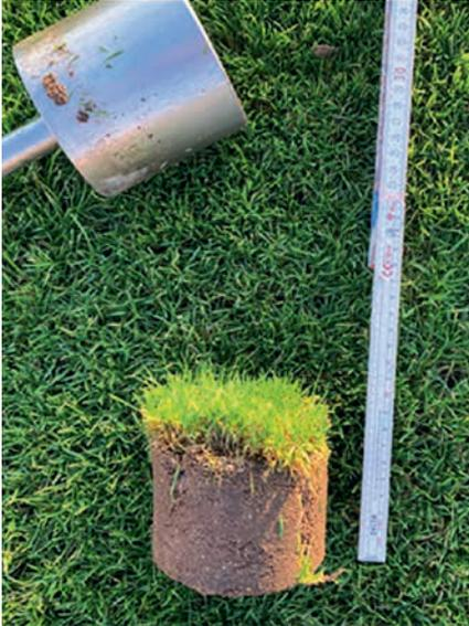
Abb. 7: Messung der Filzdicke mit Locheisen und Meterstab. (Foto: M. Schwalm)
