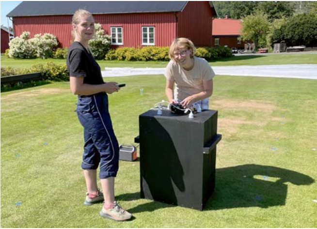
Abb. 2: Iris Eik (links) und Anne F. Borchert bei der Ermittlung des Deckungsgrades mittels Fotobox und digitaler Bildauswertung. (Foto: T.S. Aamlid)
