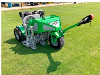
Abb. 7: Vorstellung des neuen, handgeführten „airer trike“ für die Druckluft-Lockerung von Golfgrüns und Sportplätzen.
