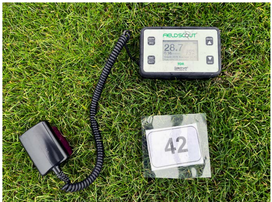
Abb. 7: Ermittlung der drei Messparameter mittels des TDR-Fieldscouts auf Versuchsparzelle 42 in Versuchswoche 2.
