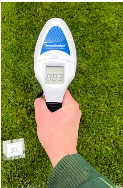
Abb. 6: Ermittlung des NDVI-Index mit dem GreenSeeker auf Versuchsparzelle 23 in Versuchswoche 3.
