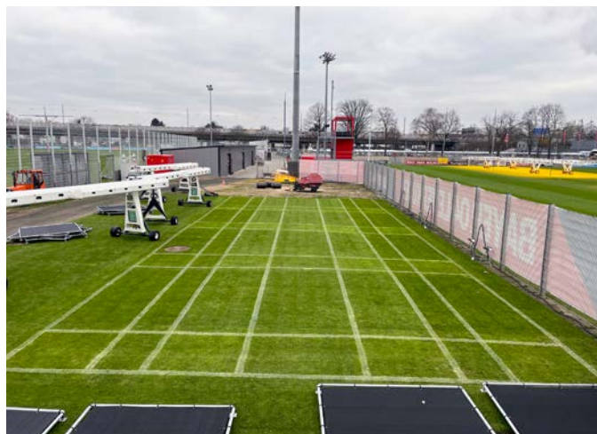
Abb. 1: Versuchsaufbau. Links: Darstellung der vier Versuchsreihen mittels Linierfarbe. Rechts: Nummerierung und Bemaßung des gesamten Versuchsaufbaus zum Zeitpunkt der Beschattung aller Versuchsreihen. (Alle Fotos: L. Baar)
