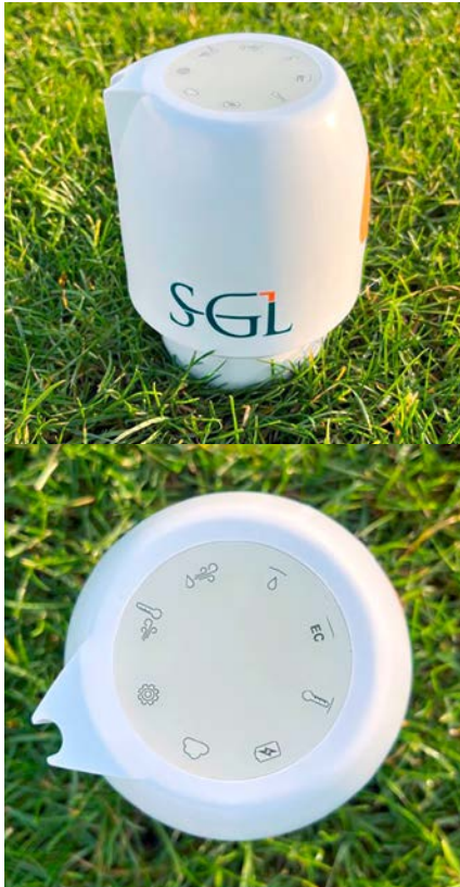
Abb. 5: TurfPod der Firma SGL zur Ermittlung des Daily Light Integrals.
