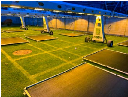
Abb. 2: Belichtung der Versuchsreihe 2 in Versuchswoche 3 im Belichtungsintervall 8 Stunden. Im Einsatz die Beleuchtungssysteme LU120 der Firma SGL. Im Hintergrund die Versuchsreihen 3 und 4.
