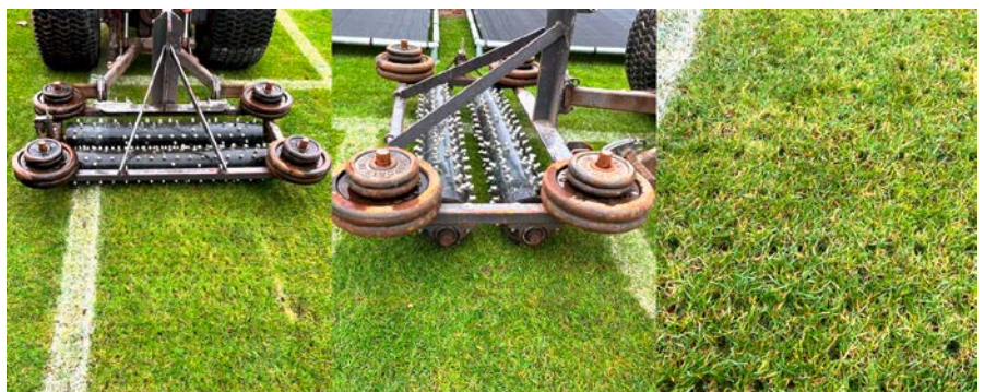
Abb. 4: Vom Kleintraktor gezogene Stollenwalze mit zwei hintereinander laufenden Walzen und dadurch resultierende Schäden in der Grasnarbe.
