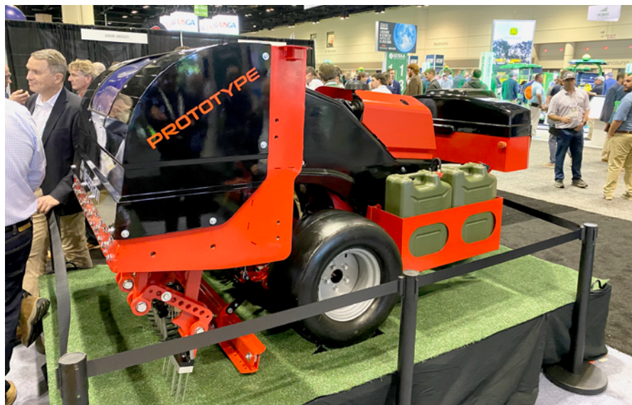
Abb. 2: Die Fa. Wiedenmann stellt einen ferngesteuerten Aerifizierer vor. Zur Arbeitserleichterung kann sich der Bediener abseits aufhalten und ist damit vor Belastung durch das Arbeitsgerät geschützt. Kleines Detail: Der Tank sind die tragbaren Kanister, so kann auf umweltgefährliche Tankvorgänge verzichtet werden.
