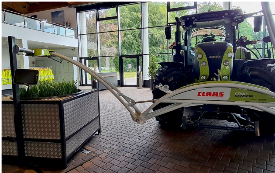
Abb. 3: Frontanbau eines Crop-Sensors zur Steuerung der stand ortspezifischen Düngermenge.
