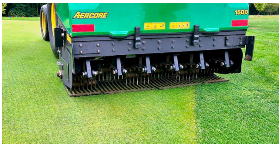
Abb. 4: Die regelmäßige mechanische Bearbeitung mit „Needle Tines“, zur Öffnung der Grüns Oberfläche, zählt auf der Golfanlage Brückhausen zur Standardpflege.
