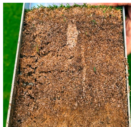
Abb. 5: Beurteilung des Bearbeitungshorizontes mittels Profilspaten am Grün 18. Hierbei werden unterschiedliche Bearbeitungstiefen sichtbar.
