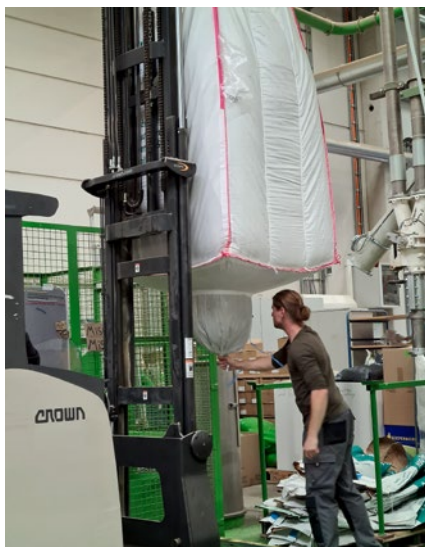
Abb. 9: Befüllung der Mischanlage aus dem Big Bag, Zuführung erfolgt über einen „Sumpf“.
