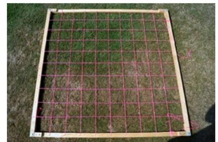
Abb. 7: Schätzrahmen mit der Größe 1x1 m nach DIN EN 12231.
