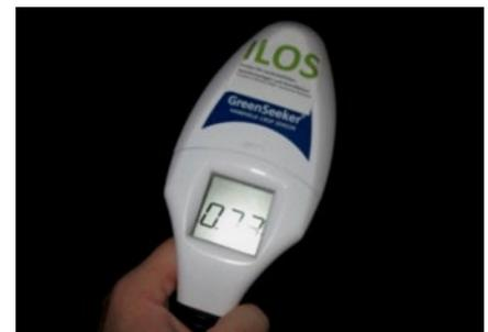
Abb. 9: GreenSeeker zur Ermittlung des NDVI.
