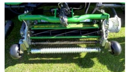
Abb.1: Mäheinheit eines Spindelmähers. (Foto: K.G. MÜLLER-BECK)
