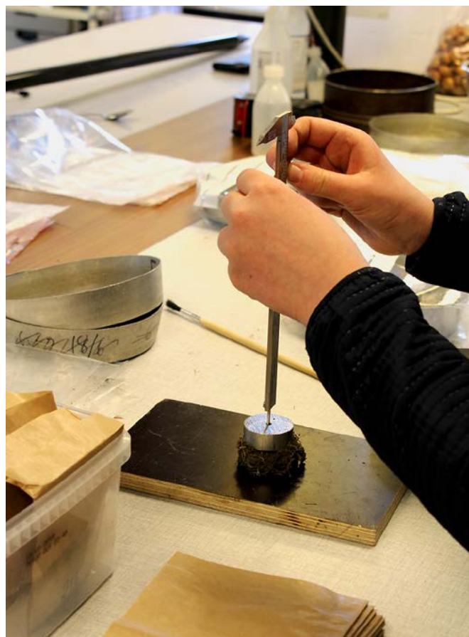
Abb. 6: Die Dicke der Soden wurde im Labor mit Hilfe einer Messlehre ermittelt. Im Anschluss wurden die Proben getrocknet und verascht, um den Anteil an anorganischem Material zu bestimmen.
