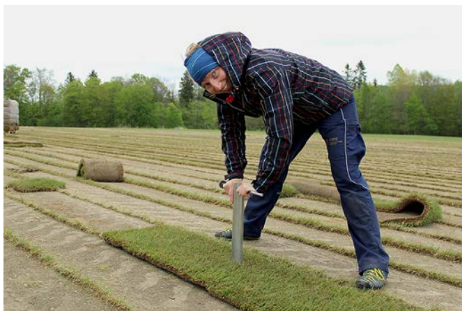
Abb. 5: Mittels eines Lochstechers schneidet Anne F. Borchert jeweils fünf Proben pro Rasensode heraus, um deren Dicke zu messen.
