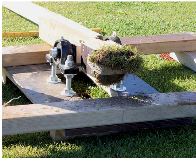
Abb. 3: Durch schwungvolles Ziehen am langen Griff des selbstgebauten Divot-Gerätes wurden gleichbleibend große Divots aus der Grasnarbe im Mähroboter-Versuch herausgeschlagen.
