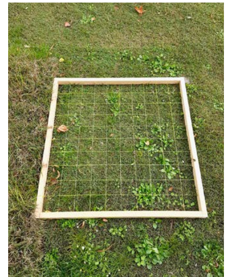
Abb. 14: Zählrahmen zur Bestimmung des Deckungsgradanteils der Gräser und der zweikeimblättrigen Kräuter.
