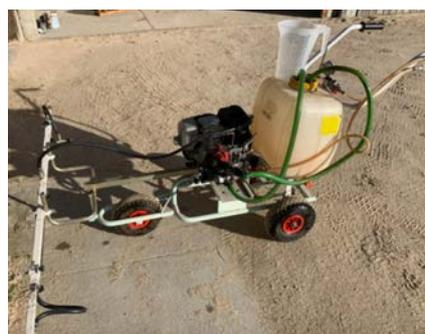
Abb. 8: Fox Sprayer für Flüssigdünger-variante
