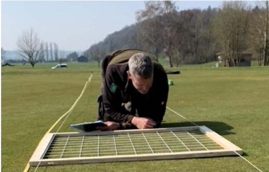
Abb. 6: Bonitur des Deckungsgrades mittels Schätzrahmen (1 m<sup>2</sup>).
