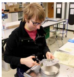
Abb. 2: Für den Wachstumstest entnimmt A.F. Borchert aus den vakuumierten Grasproben, die zuvor im Kühlschrank für fünf Wochen gelagert wurden. Probenmaterial für die weitere Bearbeitung.
