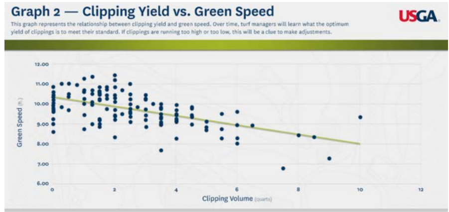
Abb. 4: Die Grafik zeigt das Schnittgutvolumen im Vergleich zur Grüngeschwindigkeit. Es gibt einen „Sweet Spot“ für das Schnittgutvolumen für eine bestimmte Grüngeschwindigkeit, die grafische Darstellung macht dies leicht erkennbar. In gewisser Weise ist eine schnelle Überprüfung des Schnittgutvolumens ein Indikator dafür, wo die Grüngeschwindigkeit liegen wird. Wird zu viel Schnittgut produziert, so ist es schwieriger, den Zielbereich für eine angestrebte Ball-Roll-Distanz (BRD) zu erreichen. (Anmerkung: Quarts/1.000 Square Feet entspricht etwa l/100 m 2 ). (Quelle: USGA; HARTWIGER, 2019)
