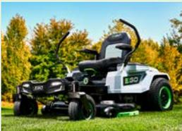
Bei einer Schnittbreite von 106 cm erreicht dieser Akku-betriebene Null-Wendekreismäher von Ego eine Flächenleistung von bis zu 10.000 m<sup>2</sup> mit einer Ladung. Verwendet werden sechs 56-V-Akkus, die gewechselt werden können. Es sind dieselben Typen, wie sie bei den Handgeräten von Ego, wie zum Beispiel Trimmern oder Heckenscheren zum Einsatz kommen.
