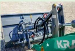
Mit dem vollhydraulischen Schnellwechsler Smart Attach von Kramer können hydraulische Anbaugeräte von Ladem aus der Kabine heraus gekoppelt werden. Die Verbindung mit dem Hydraulikkreislauf erfolgt automatisch. Das ist effizient und sicher, weil nicht mehr abgestiegen werden muss. Zudem tritt kein Lecköl aus.
