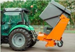
Der Bema-Kippcontainer mit Hochentleerung und einem Volumen von 1.350 l ist Bestandteil des Saug-Kehr-Systems dieses Herstellers. Er hängt in der Traktor-Dreipunkt. Kombiniert werden kann er mit verschiedenen Geräten des Herstellers, zum Beispiel einer Kehr-Saug-Bürste, einem Häckselgebläse oder mit Produkten von anderen Lieferanten.
