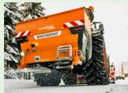
Beim Winterdienststreuer IceTiger von Amazone sorgt die Kombination aus einem hydraulisch angetriebenem Bandboden, elektrischer Aufgabepunktverstellung und der Bedienung über ISOBUS-Terminal für eine präzise Ausbringung des Streugutes, auch in Kleinstmengen von
