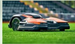
Der Mähroboter Ceora von Husqvarna ist als Multifunktionsgerät konzipiert. Künftig werden neben dem konventionellen Mähdeck auch noch andere Anbaugeräte, wie ein Fairway-Deck oder ein Linienzeichner für den Sportplatz erhältlich sein. Das Gerät arbeitet kabellos, gesteuert wird es per Satelliten-Navigation mit einer Genauigkeit von zwei bis drei cm.
