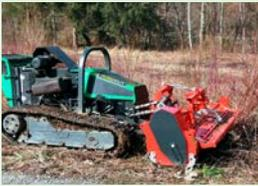
Zielgruppe des Gestrüppmulchers PS145 von Humus sind vor allem Anwender im Forst oder der Kommune. Durch sein geringes Gewicht (ab 210 kg) eignet er sich besonders für den Einsatz an ferngesteuerten Mähraupen. Er arbeitet mit dem Safety-Messer-System, das für diese Anwendung angepasst wurde.
