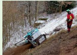
Der Moritz Fr75 von Pfanzelt vereint die Eigenschaften einer Forst- und einer Funkraupe. Dadurch ist er besonders vielseitig einsetzbar. Die Dreipunktaufnahme in Verbindung mit mechanischer Zapfwelle, Leistungshydraulik und sechs Hydraulikfunktionen ermöglicht den herstellerunabhängigen Anbau unterschiedlicher Geräte.
