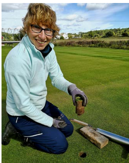
Abb. 3 a, b: Entnahme von Bodenzylindern, um Wurzellängen im SUSPHOS-Projekt zu messen (li.) und Auswaschen von Wurzeln zur Trockenmasse-Bestimmung im ICL-Projekt (re.).
