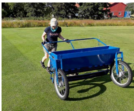
Abb. 2: Mit diesem selbstgebaute Düngestreuer werden größere Versuchspartellen exakt gedüngt.
