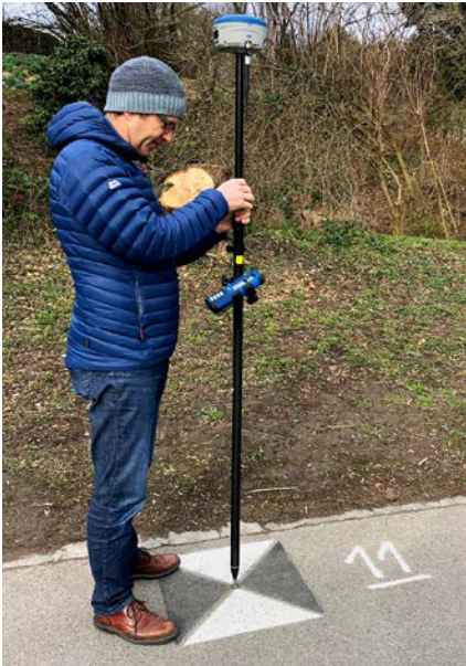
Abb. 3: Aufnahme der Passpunkte.
