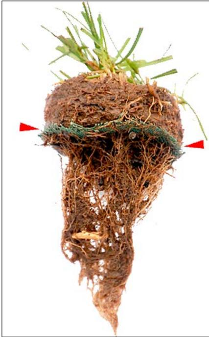
Abb. 3: Durchwurzelung eines Gewebes, Maschenweite 0,8 mm x 0,8 mm.
