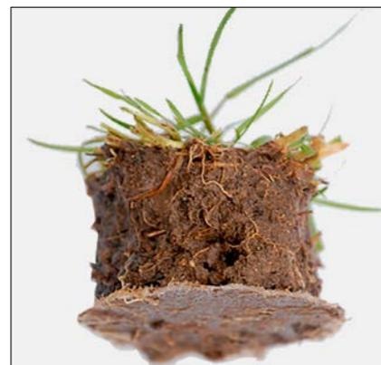
Abb.1: Schwache Durchwurzelung eines Gewebes aus Spinnvlies.
