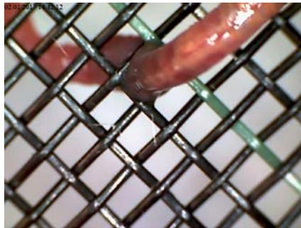
Abb. 8: Maschenweite 1,1 mm x 1,7 mm Wurmumfang: 10 mm, Wurmdurchmesser: 3,26 mm.
