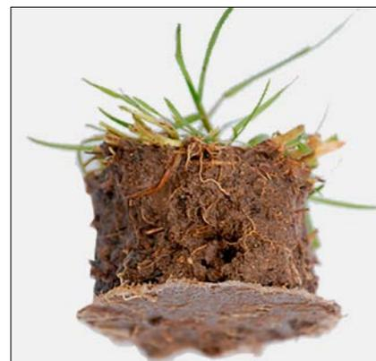
Abb.1: Schwache Durchwurzelung eines Gewebes aus Spinnvlies.
