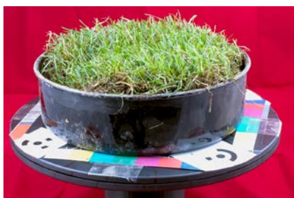
Abb. 4: Drehteller mit Fernsehtestbild, Referenzpunkten und Pflanzschale.
