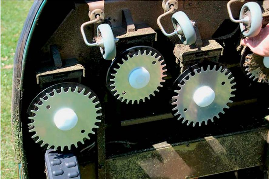
Abb. 3: Ballabweisender Schutz zur Vermeidung von Schäden an Golfbällen.
