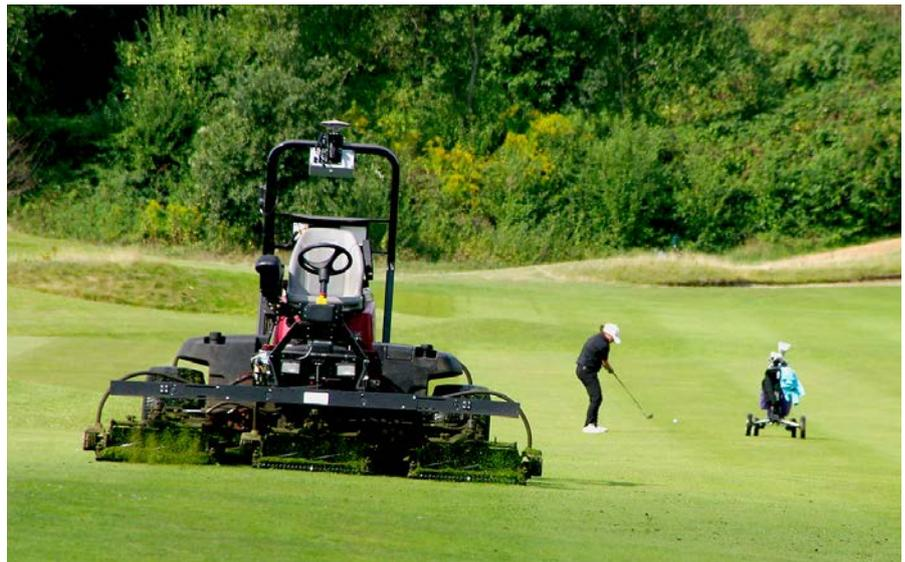
Abb.2: Professioneller Einsatz eines Fairwaymähers mit autonomer, georeferenzierter Steuerung durch GPS-Daten.
