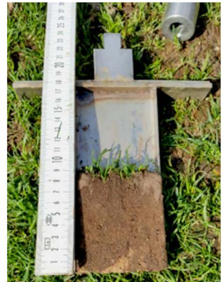
Abb. 4: Bodenprofil der Rasentragschicht.
