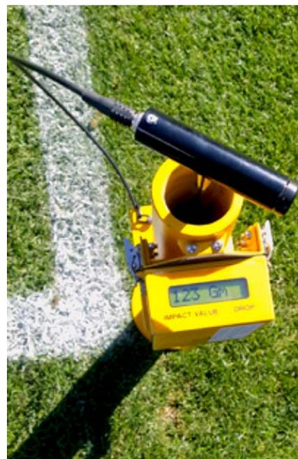
Abb. 6: Digitalanzeige des Clegghammers mit Messergebnis in Gm.
