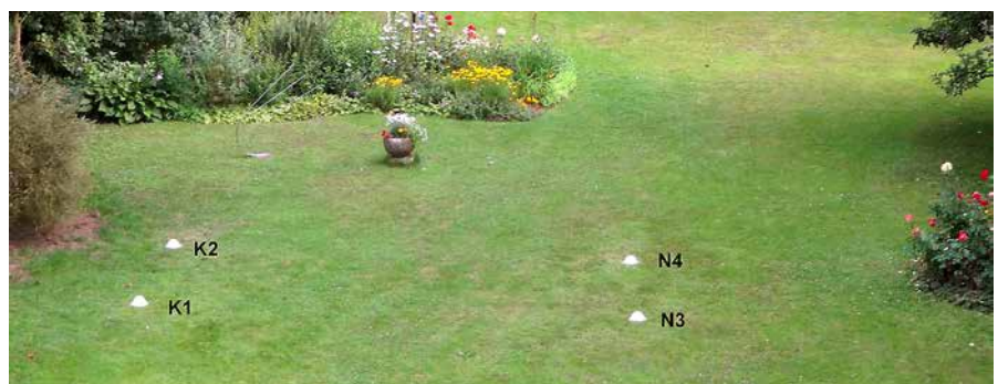
Abb. 4: Position von vier Grablöchern für EC5-Sensoren. In jedem Grabloch wurde jeweils ein Sensor in 7 cm und in 20 cm Tiefe horizontal eingestochen. Aufnahme am 5.7.2017.
