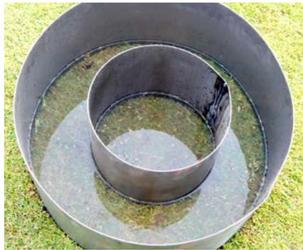
Abb. 6: Doppelring-Infiltrometer mit äußerem Ring 60 cm Durchmesser zur Vorsättigung und innerem Ring 30 cm Durchmesser zur Infiltrationsmessung. Die Höhe beträgt 30 cm.
