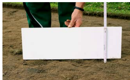
Abb. 9: Unebenheiten nach dem Abfräsen der Hybrid-Tragschichtvarianten. Texturierte Fasern neigen bei entsprechender Arbeitstiefe zur erhöhten Unebenheit.
