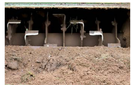
Abb. 2: Winkelmesser des Field Top Makers zum Abschälen der Hybrid-Tragschichtgemische.
