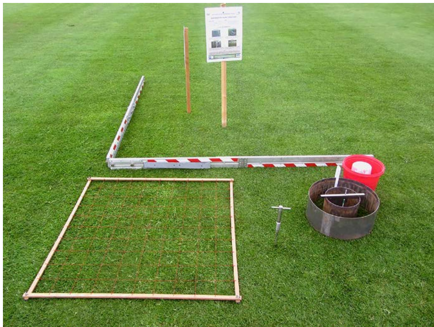
Foto 1: Hilfsmittel/Messgeräte zur Überprüfung der Qualitätsparameter Narbendichte, Wasserdurchlässigkeit, Scherfestigkeit und Ebenheit.
