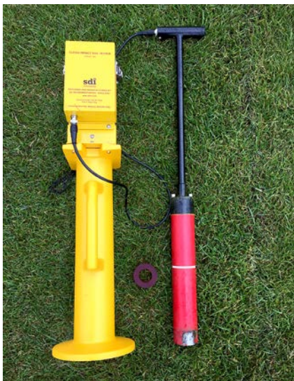
Foto 3: Führungsrohr, Fallgewicht, Datenlogger und Kalibrierung des Clegg Soil Impact Testers „Clegghammer“.
