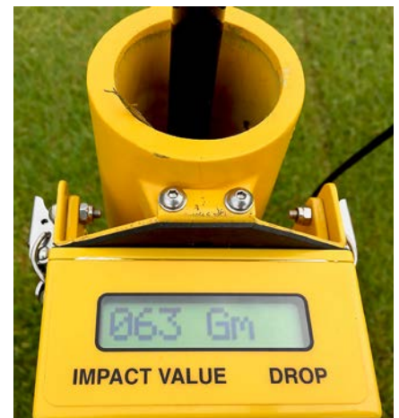
Foto 5: Digitale Anzeige und Speicherung des Messwertes bieten direkte Information und spätere Dokumentation.
