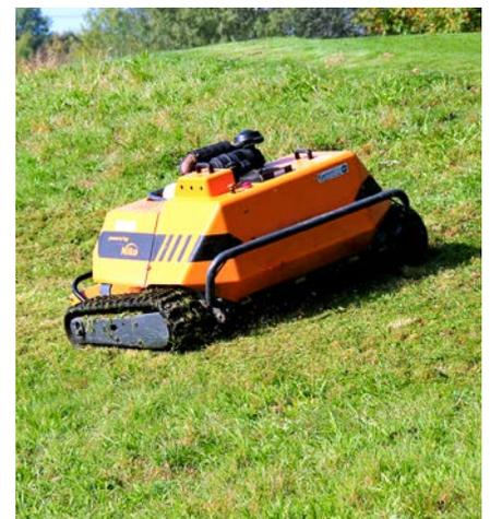
Abb. 3: Ferngesteuerter Böschungsmäher.
