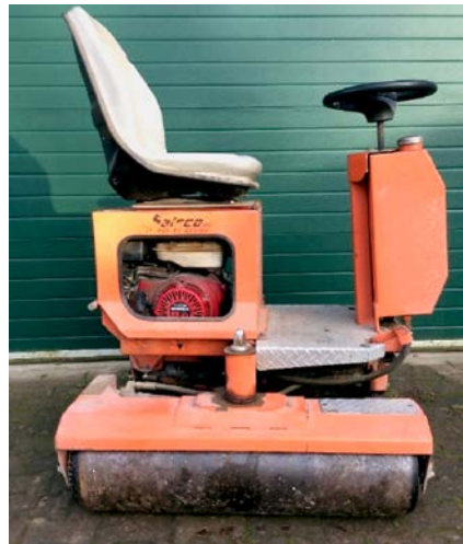
Abb. 1: Salsco-Walze, Arbeitsbreite 0,90 m, Gewicht 155 kg.
