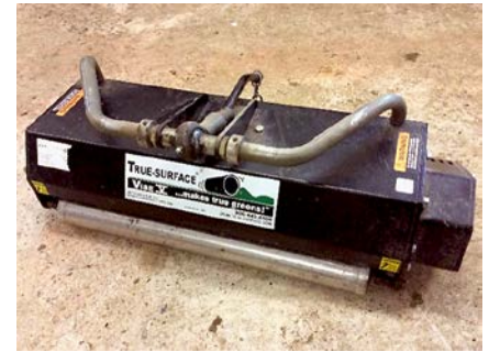
Abb. 2: Vibrationswalze, Arbeitsbreite 1,50 m.
