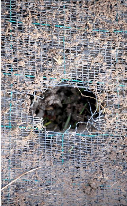
Abb. 4: Durch Fraß von Nagern zerstörte Barriere.
