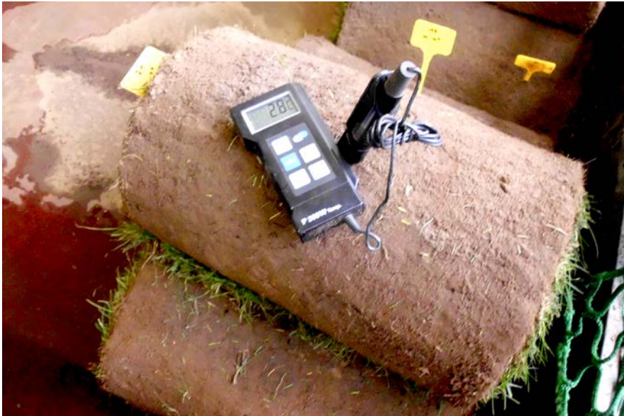
Abb. 1: Prüfung und Entwicklung der Soden-Innentemperatur bei unterschiedlichen Lagerungstemperaturen.
