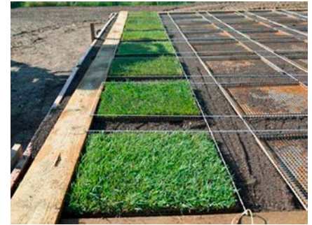
Foto 1: Versuchsanlage. Rechts im Bild die Lochblechkörbe zur Aufnahme der Fertigrasenstücke.
