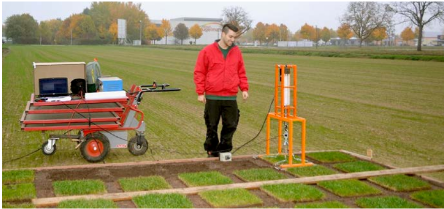
Foto 2: Bestimmung der Verwurzelung, 20 Tage nach dem Verlegen, durch Messung der zum Abheben der Fertiggrasstücke erforderlichen Zugkräfte.
