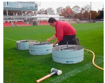
Abb. 5: Doppelringinfiltrimeter-Methode zur Messung der Wasserinfiltrationsrate im Feldversuch.
