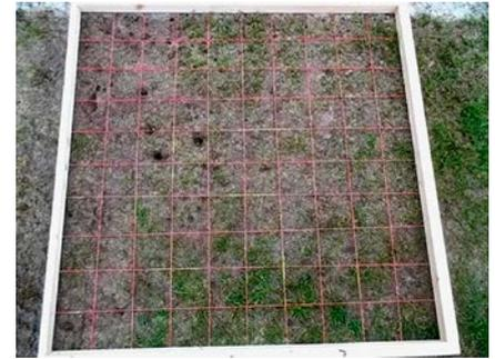
Abb. 4: Schätzrahmen zur Ermittlung der Narbendichte (Deckungsgrad in 5).
