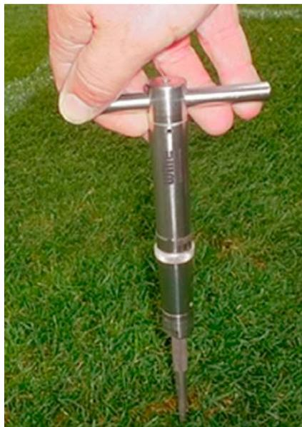
Abb. 3: Scherfestigkeitsmessung mit einer Flügelsonde.
